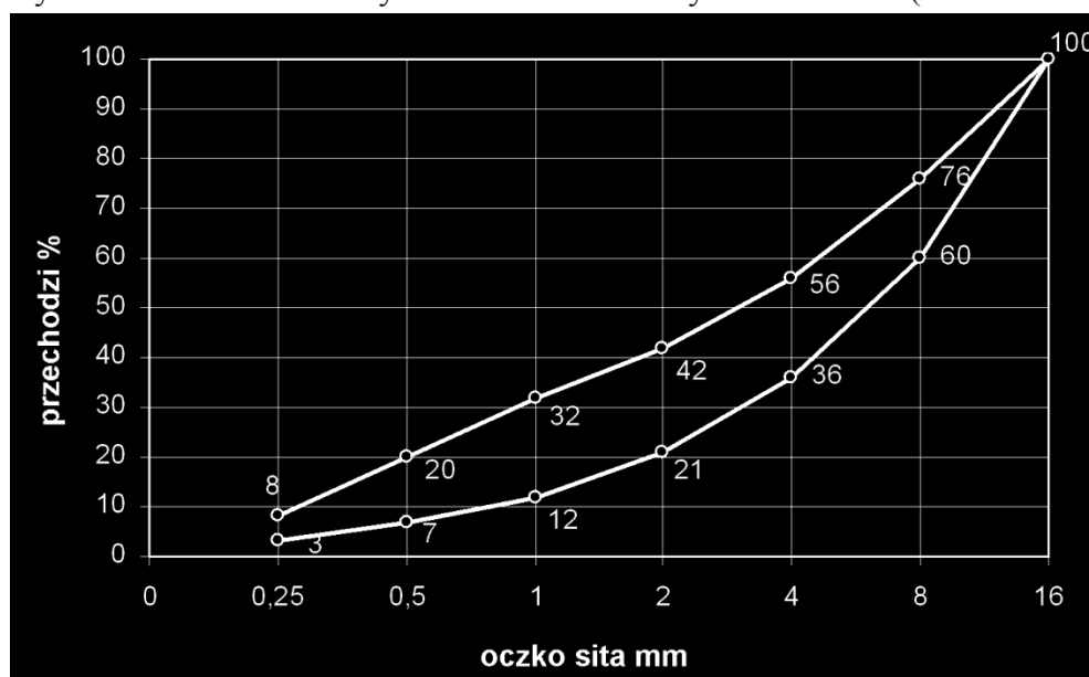
Rysunek 1. Graniczne krzywe uziarnienia kruszywa 0 ÷ 16 mm (dla betonu klasy C25/30)
