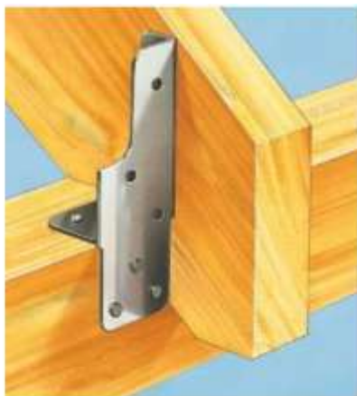
Rys. 5. Łącznik do łączenia krokwi do murlaty [4]
