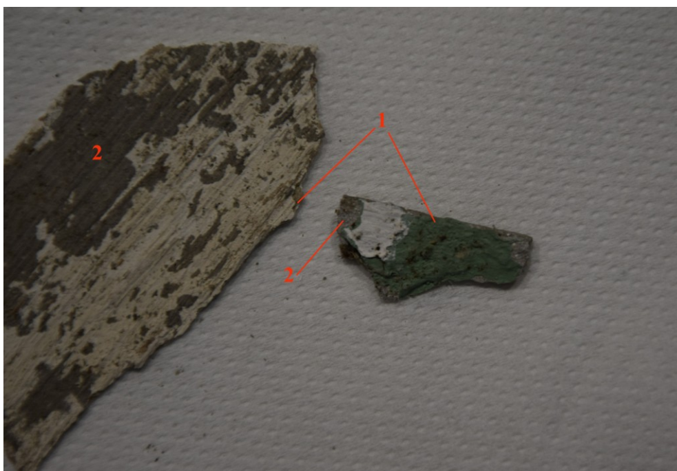
17. Dwa fragmenty łuski pobranej ze stropu w punkcie 9. Widoczna warstwa zielonej farby olejnej (1) na cementowej zacierce (2), a na wierzchu resztki późniejszych warstw.
