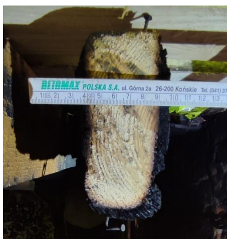
Rys 17. Głębokość zwęglenia krokwi
