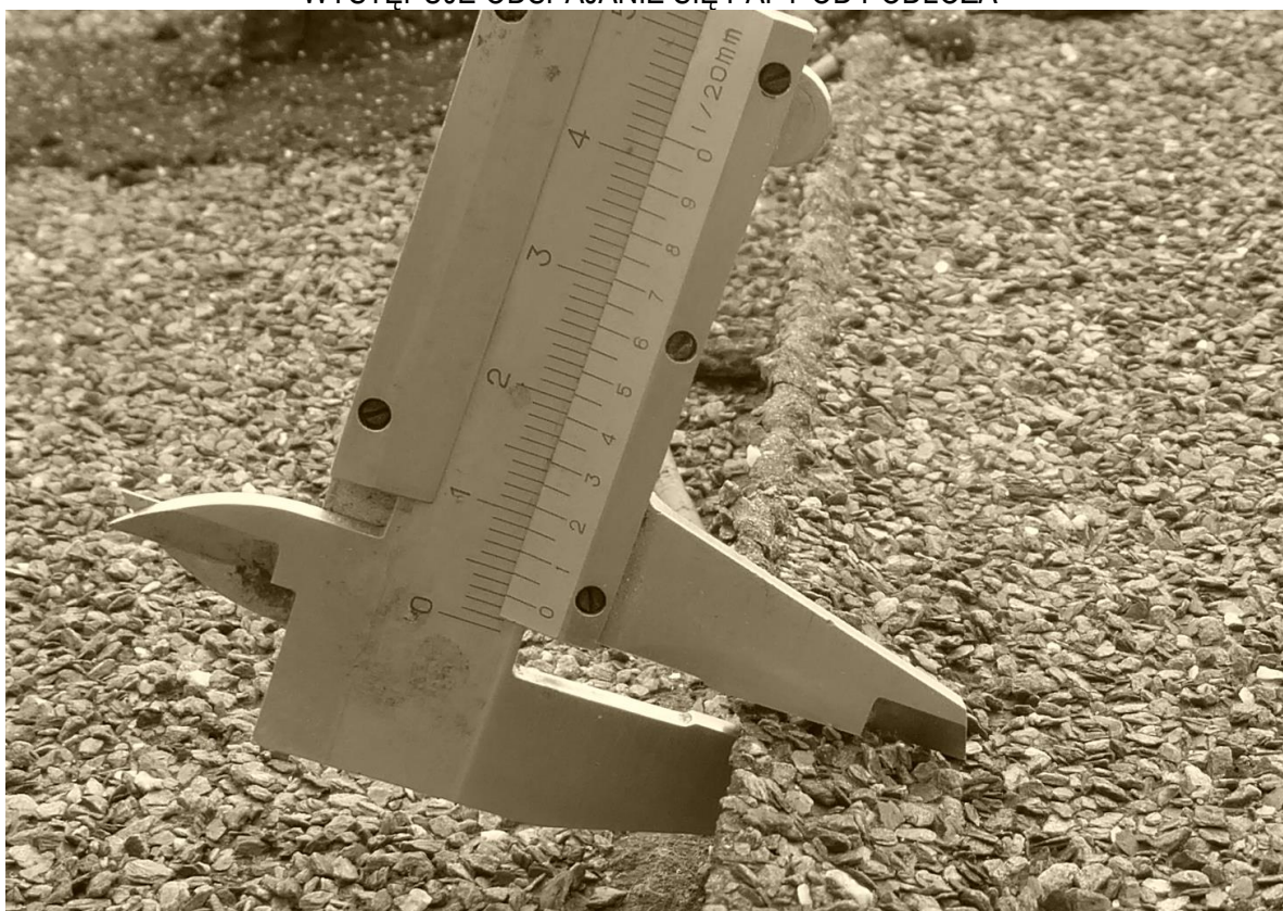
PRAWDOPODOBNE JEST ZASTOSOWANIE POPY NAWIERZCHNIOWEJ O GRUBOŚCI OKOŁO 3,5-4MM
