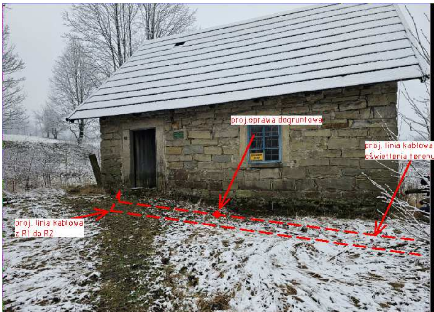
Rys. 5 Trasa linii kablowej od rozdzielnicy R1 w budynku cerkwi do rozdzielnicy R2 w bud. spichlerza – elewacja zachodnia
