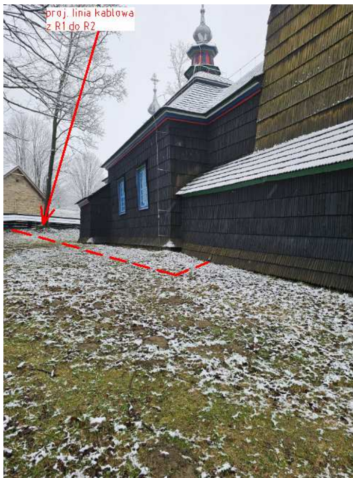
Rys. 3 Trasa linii kablowej od rozdzielnicy R1 w budynku cerkwi do rozdzielnicy R2 w bud. spichlerza
