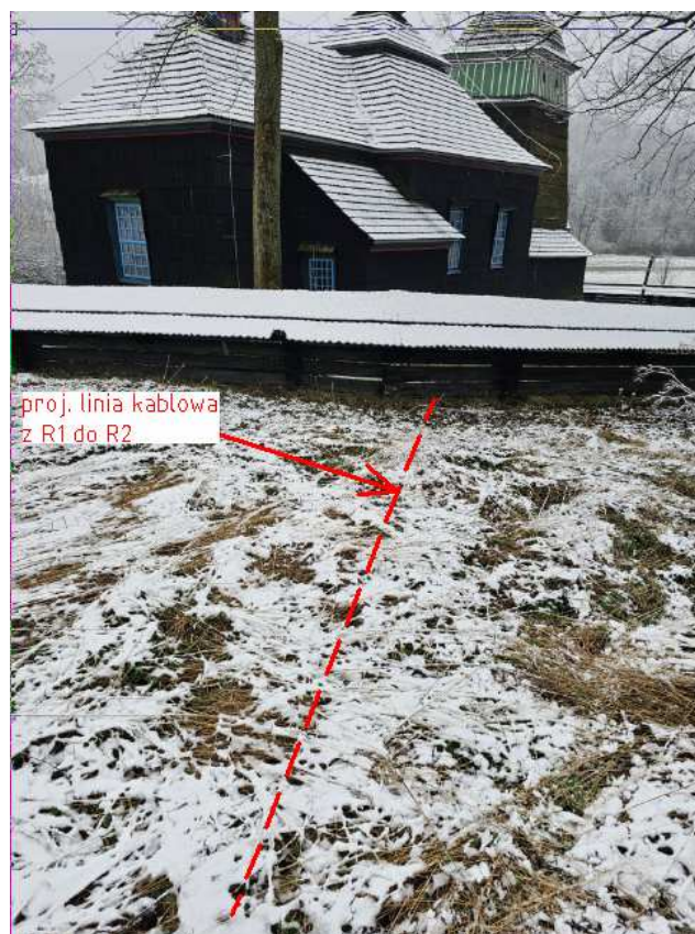
Rys. 4 Trasa linii kablowej od rozdzielnicy R1 w budynku cerkwi do rozdzielnicy R2 w bud. spichlerza
