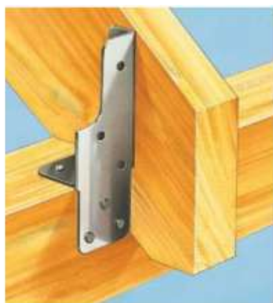
Rys. 5. Łącznik do łączenia krokwi do murlaty [4]
