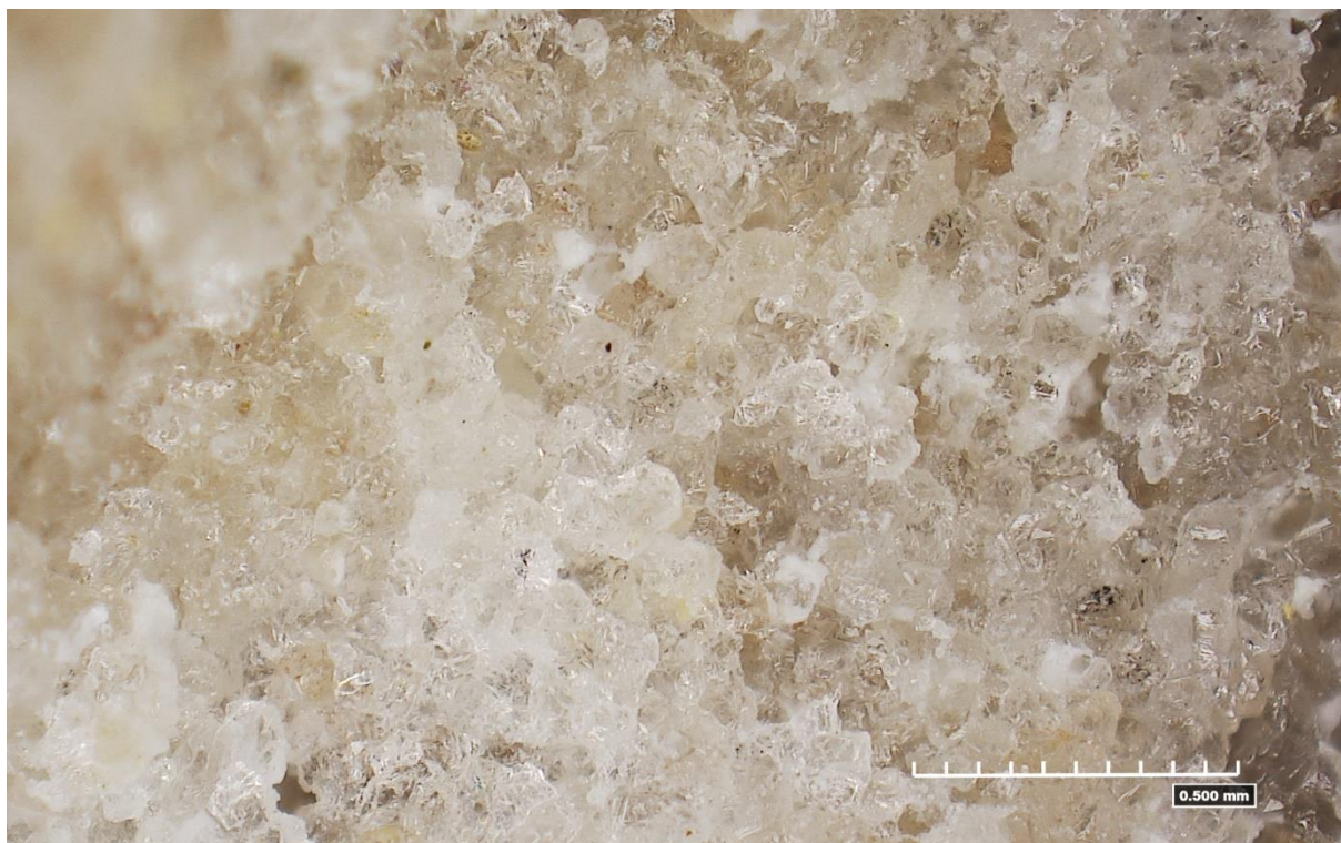
Fot. 11 Próbka K2 obserwacja mikroskopowa w pow. x 140. Piaskowiec kwarcowy, spoiwo kwarcowe, prawdopodobnie krzemionkowe.
