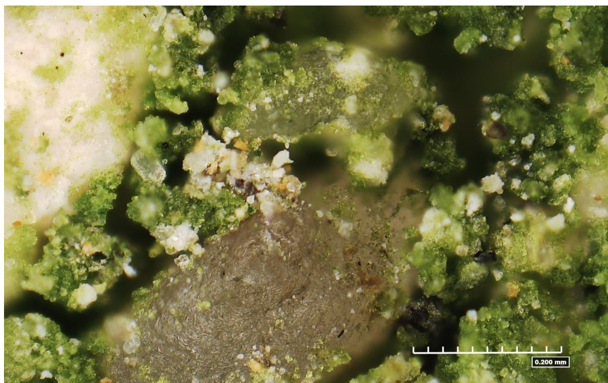
Fot. 7 Próbką G1 tynk zasiedlony przez kolonie glonów. Obserwacja mikroskopowa w pow. x 140
