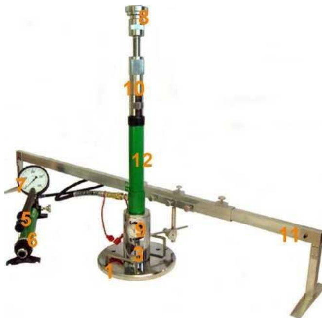
Rys. 1.2 Aparatura VSS z jednopunktowym pomiarem przemieszczenia płyty
