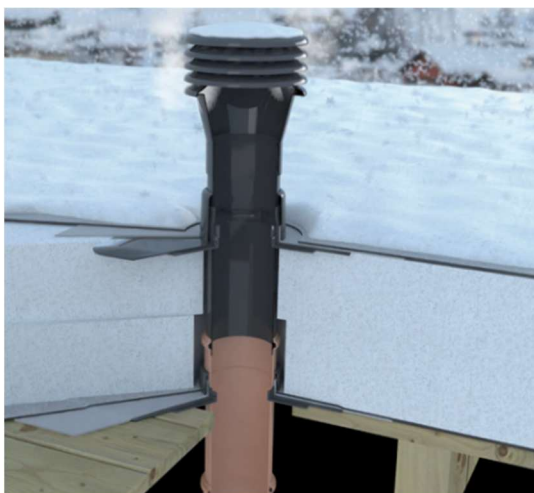
Rys. 4 Poglądowy nasady z PCV na istniejący żeliwny pion kanalizacji
