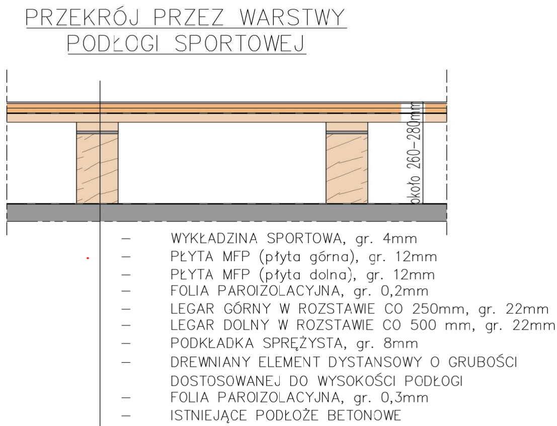
Schem. 1 Przekrój przez warstwy podłogi sportowej
