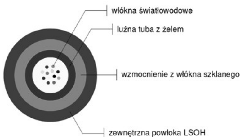
Budowa kabla światłowodowego z luźną tubą
