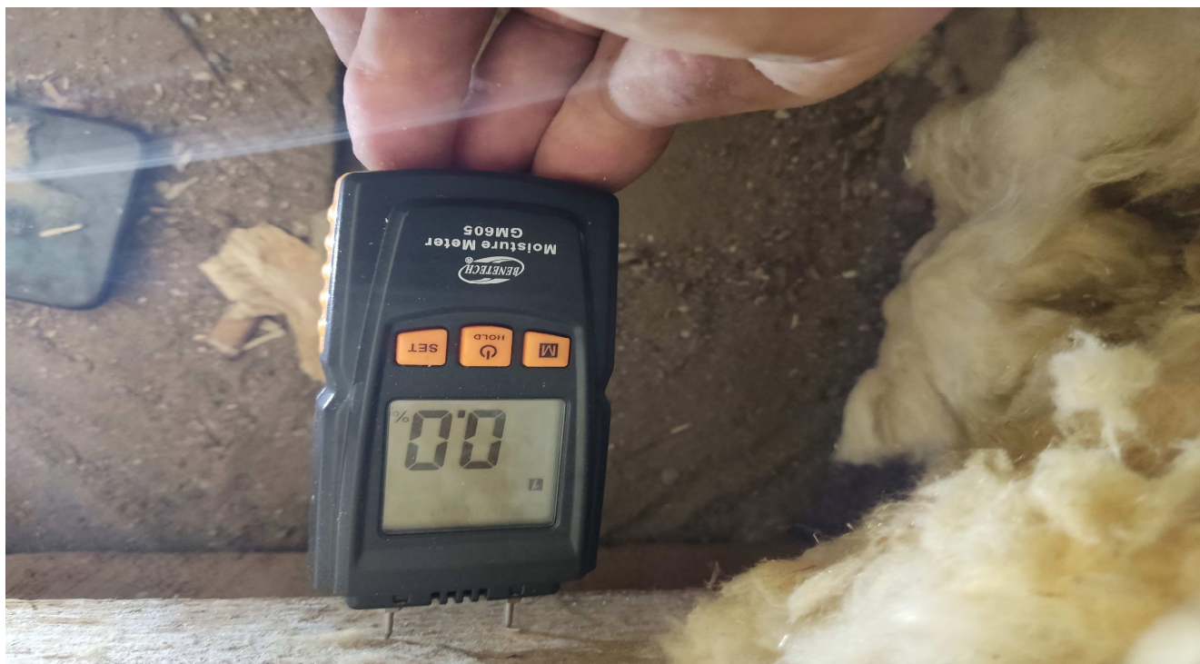
Fot. nr. 14 Pomiar wilgotności konstrukcji drewnianej
