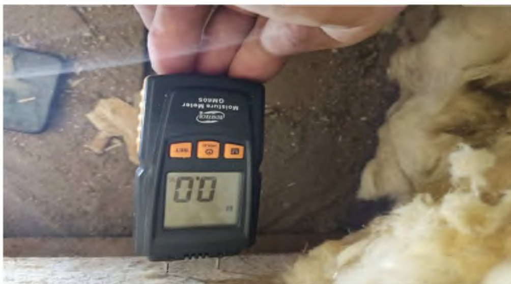
Fot. nr. 14 Pomiar wilgotności konstrukcji drewnianej
