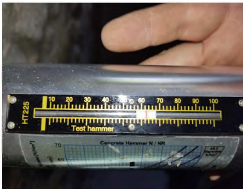
Fot. nr.2 Pomiar sklerometryczny młotkiem Schmitta
