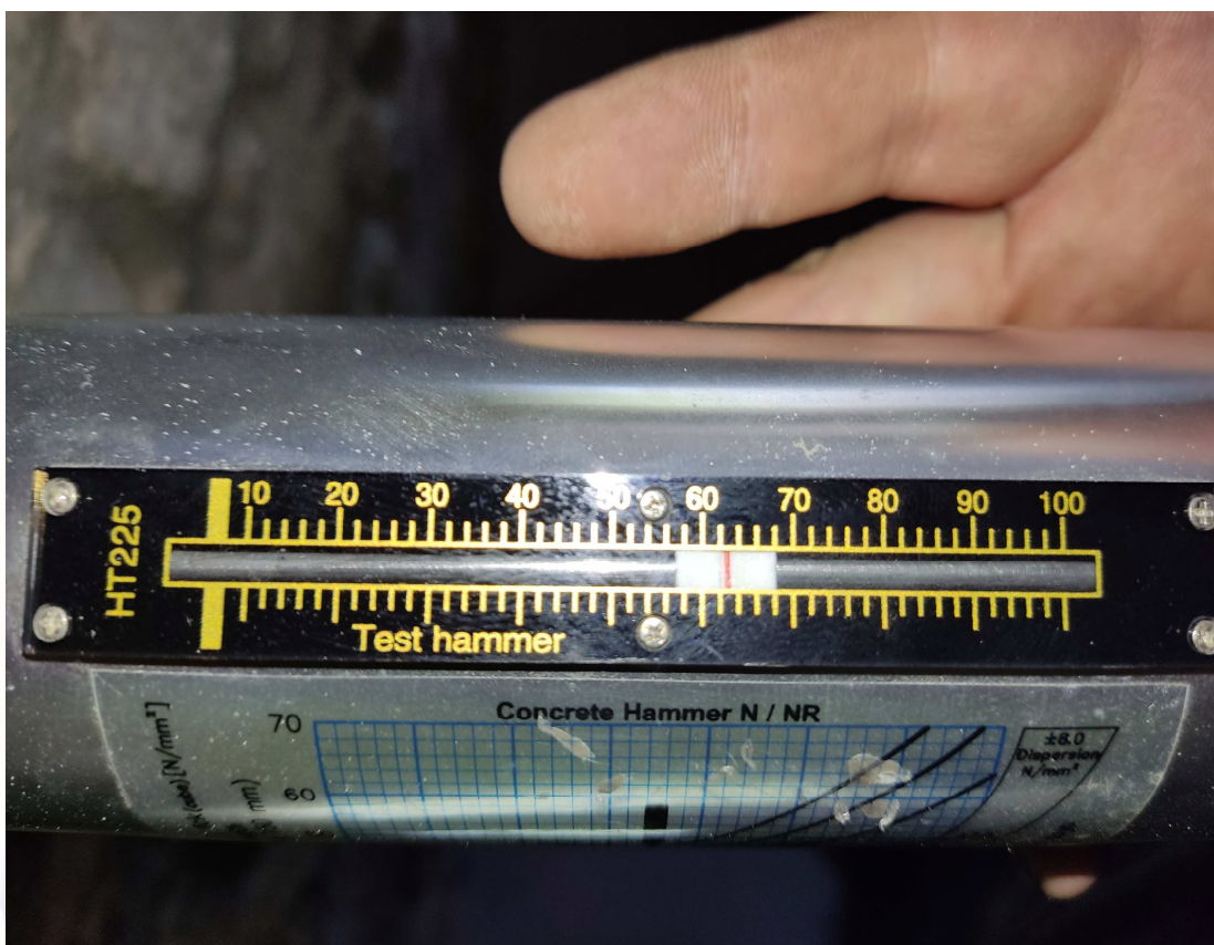
Fot. nr.2 Pomiar sklerometryczny młotkiem Schmitta
