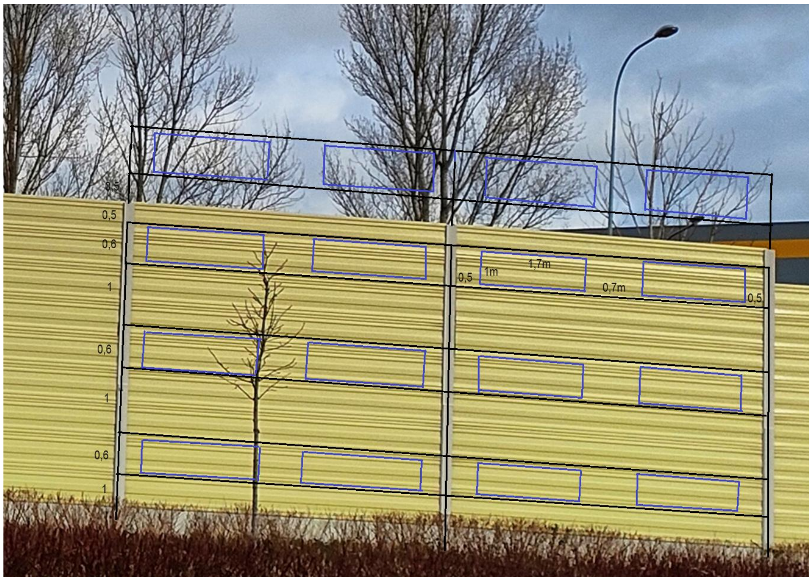
Rys. 3. Orientacyjny widok paneli umieszczonych na ekranie akustycznym na DK92 Kostrzyn z przykładowym wymiarowaniem [opracowanie własne]
