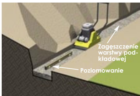
Wykonanie warstwy podkładowej, wypoziomowanie i zagęszczenie.
