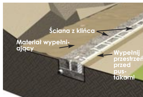
Wykonanie ściany z kłınca.
