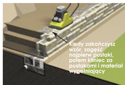
Zakończenie muru i zagęszczenie.
