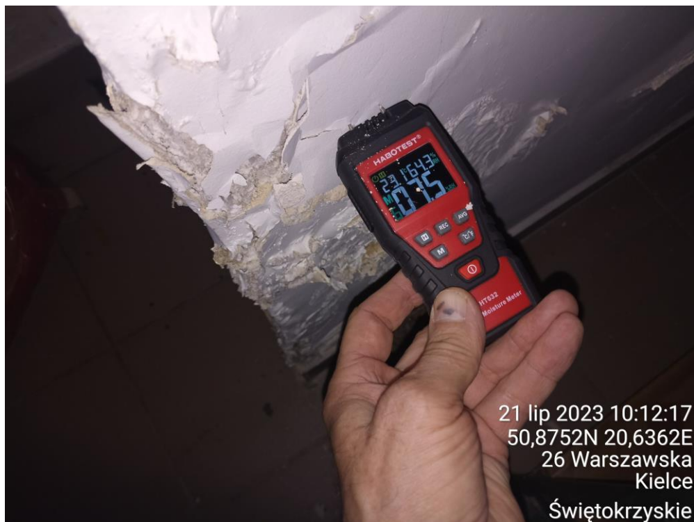
Fot. 26. Pomiar wilgotności w Schronie, – pomiar nr. 17.
