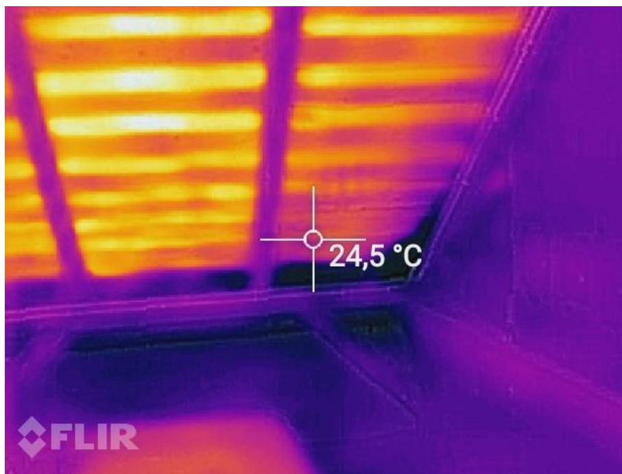
Fot.4. Obszar wilgoci w pobliżu uszkodzonego gzymsu od strony strychu.
