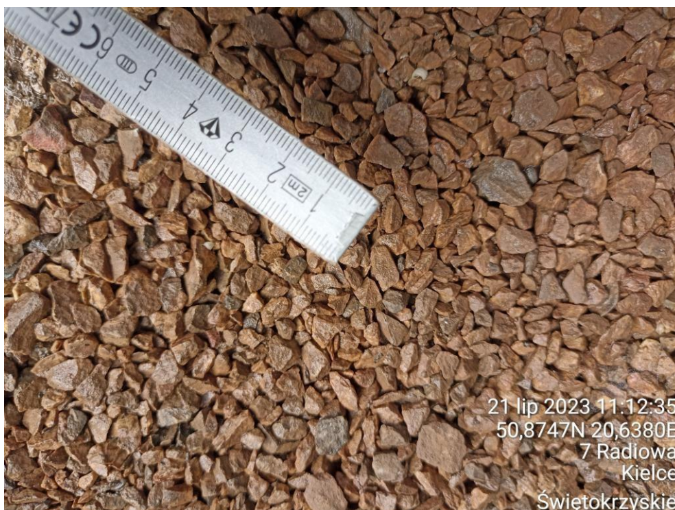
Fot. 5. Warstwa drenażowa tarasu - użyto gysu zamiast naturalnego żwiru.
