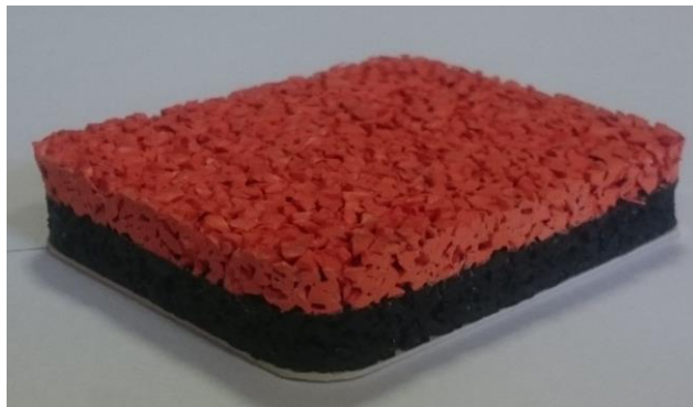
Fot.2. Przekrój przez górne warstwy nawierzchni.
