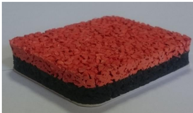
Fot.2. Przekrój przez górne warstwy nawierzchni.
