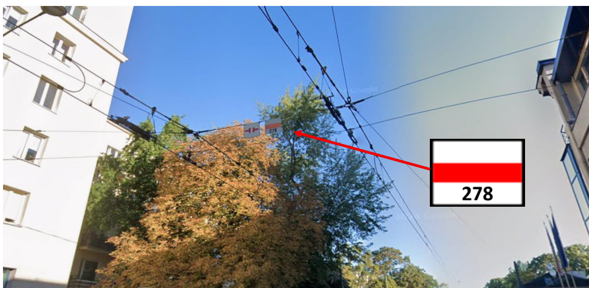
Fot. 1. Fotografia przedstawiająca izolatory sekcyjne wraz z cechą zawierającą numer izolatorów.
