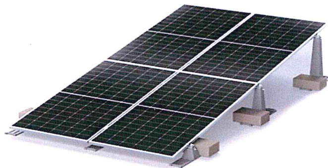
Rysunek 7. System montażu paneli na górnej powierzchni zbiornika
