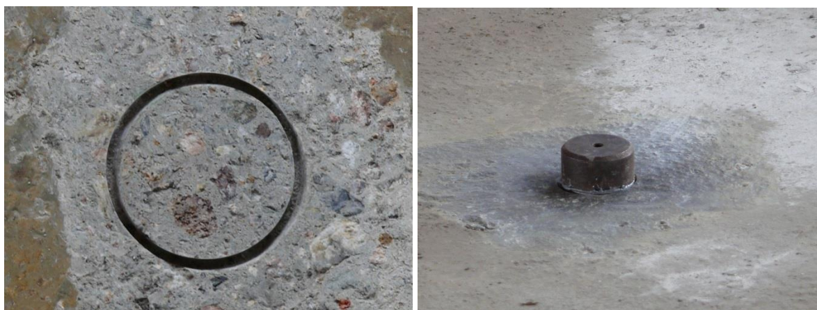
Fot. 18 Nacięcia wiertłem koronkowym oraz przyklejanie krążków pomiarowych
