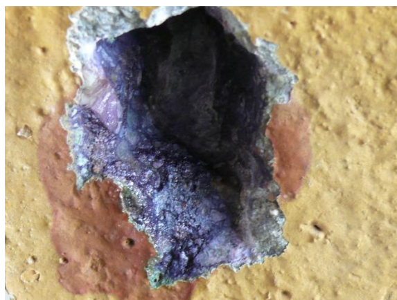
Fot. 22 Badanie pH słupów
