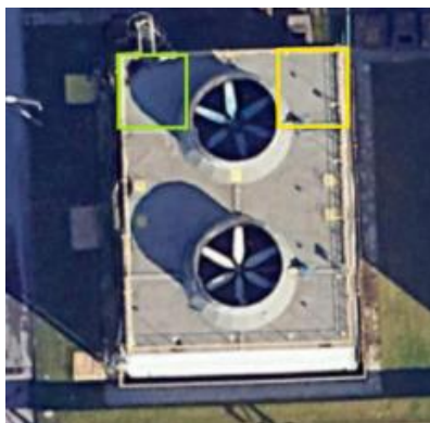
Rysunek 7. Lokalizacje głównych uszkodzeń konstrukcji wsporczej zraszalnika chłodni wentylatorowej mokrej nr 2
