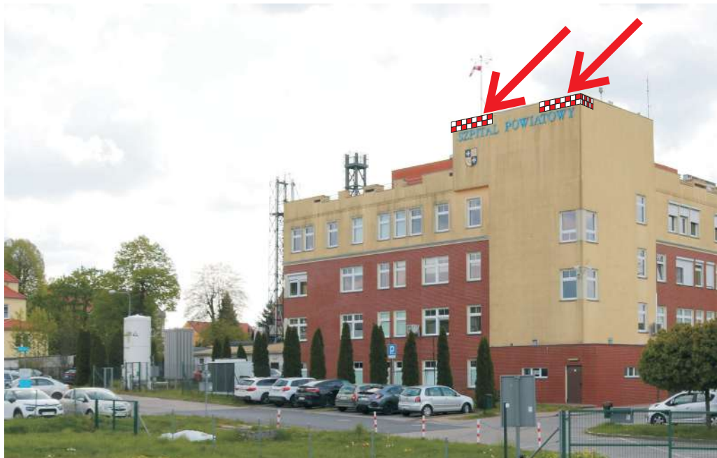
Fotografia nr 5 - Oznakowanie dzienne głównego budynku szpitala - oznakowanie dzienne - szachownica
