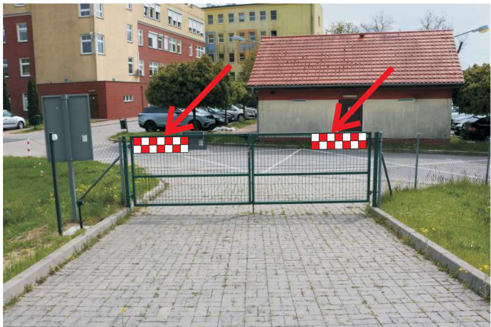
Fotografia nr 7 - Oznakowanie przeszkodowe bramy wjazdowej
