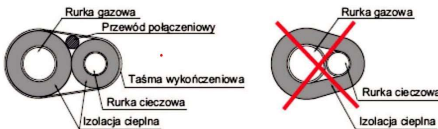
Rysunek 1. Sposób izolowania rurociągów
