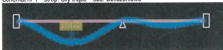
Schemat nr 1 – strop: Ugięcie stropu – obc. Charakterystyczne
