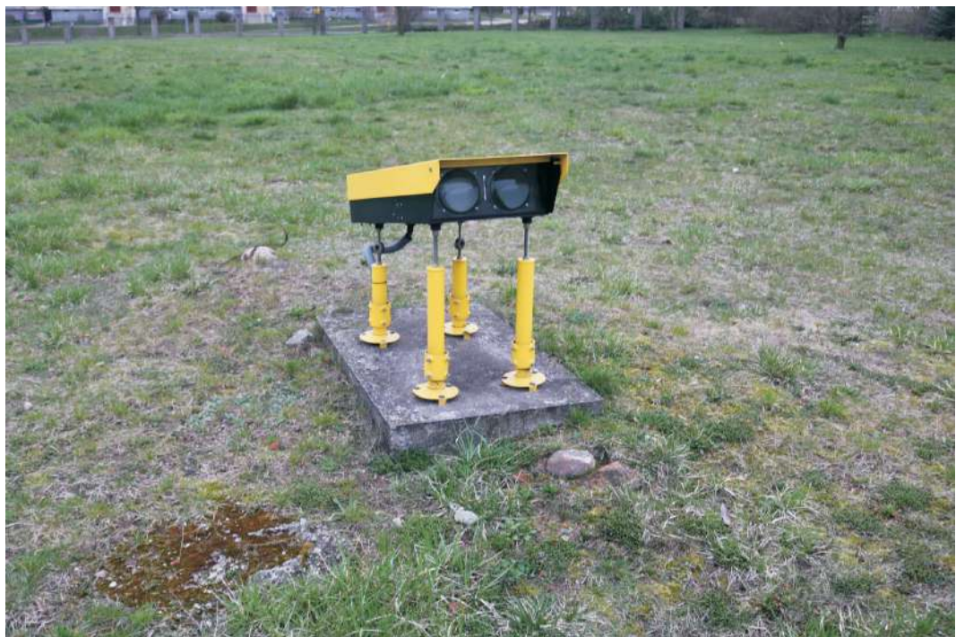
Fotografia nr 6 - Wskaźnik kąta ścieżki schodzenia HAPI
