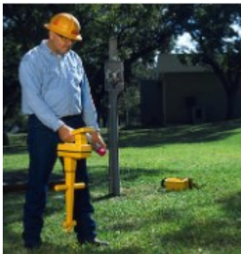
Rys. 40. Lokalizowanie i pomiar głębokości znaczników elektromagnetycznych
