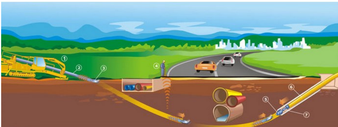
Rys. 29. Wykonywanie otworów pod kanalizację kablową metodą przewiertu
