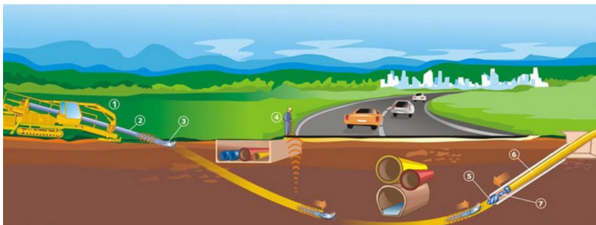
Rys. 29. Wykonywanie otworów pod kanalizację kablową metodą przewiertu
