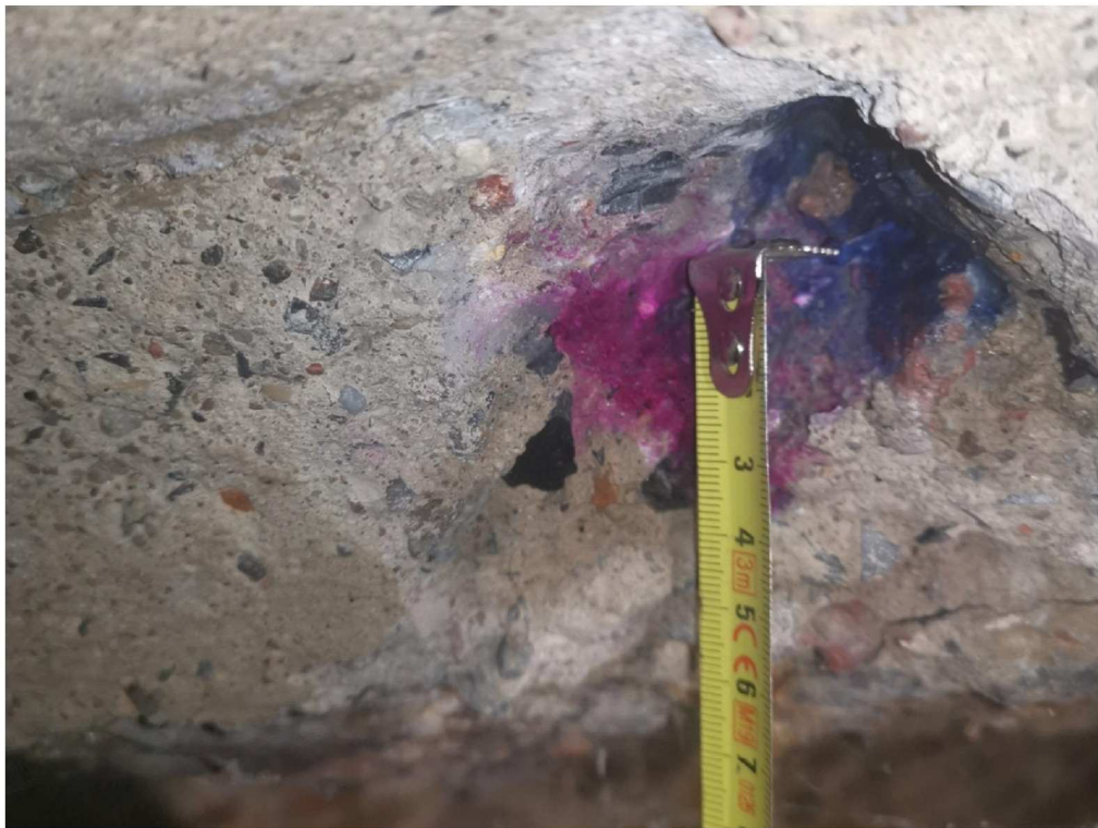
Fot. 1. Przeprowadzenie badania w miejscu odkrywki zbrojenia - głębokość dla fenoloftaleiny
