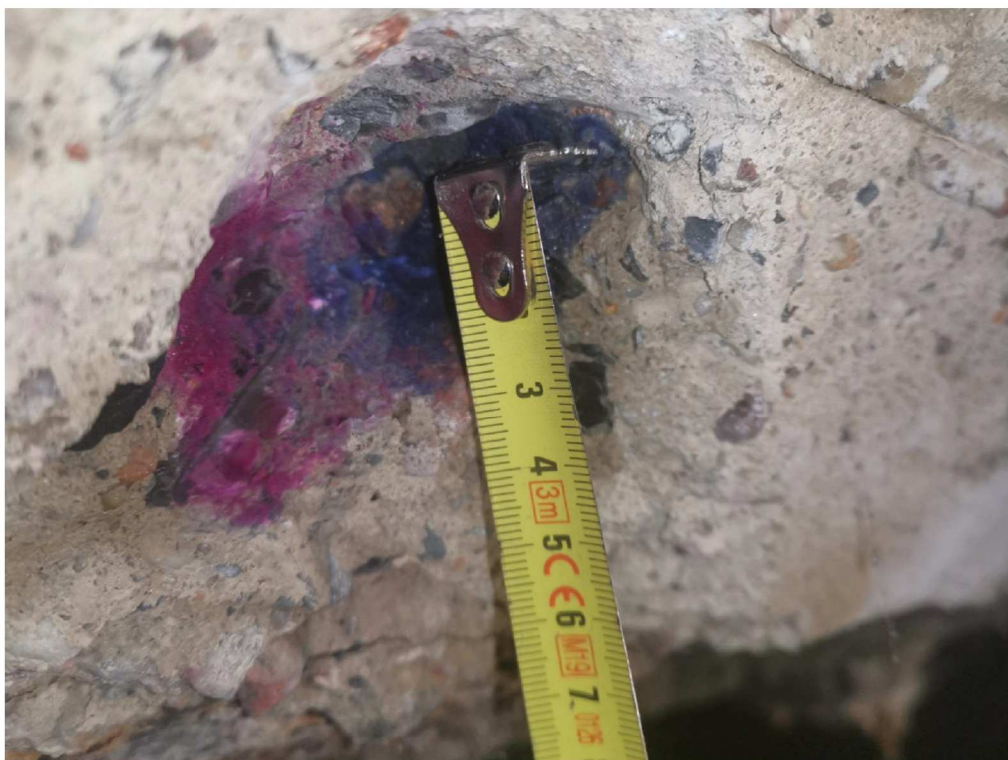
Fot. 2. Przeprowadzenie badania w miejscu odkrywki zbrojenia - głębokość dla tymoftaleiny
